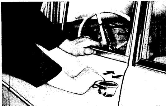
Bild 121 - Tiefeinstellung der Schließplatte prüfen
