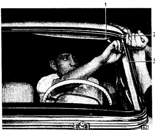
Bild 17 - Obere Zierleiste einziehen
