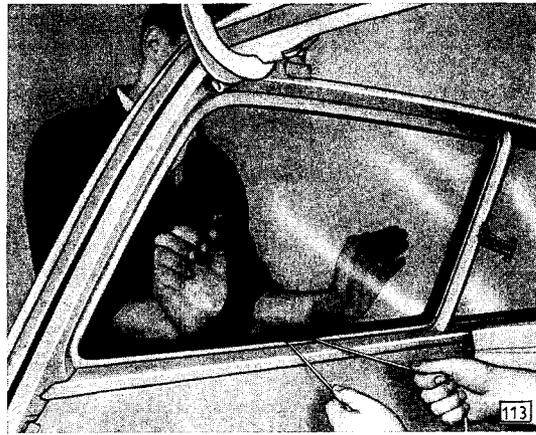
Bild 26 - Gummifassungslippe für Seitenwandfenster einziehen
