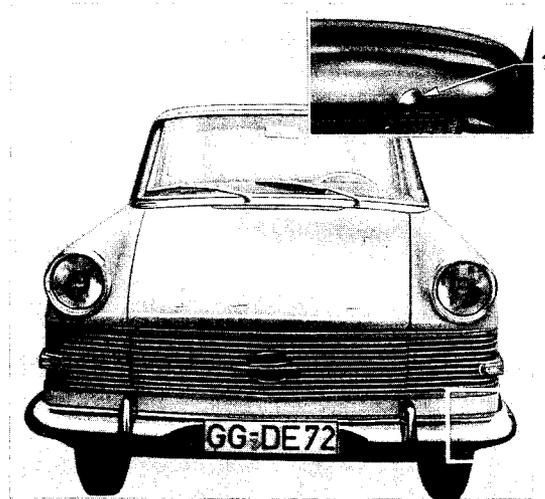
Bild 27 - Vordere Stoßstange eingebaut
