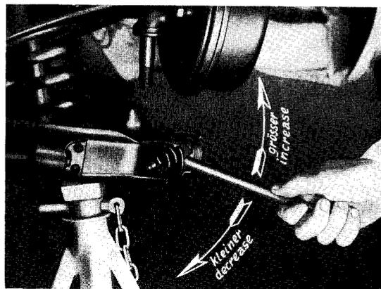
Bild 132 – Drehrichtung des Querstückes bei NachlaufEinstellung
