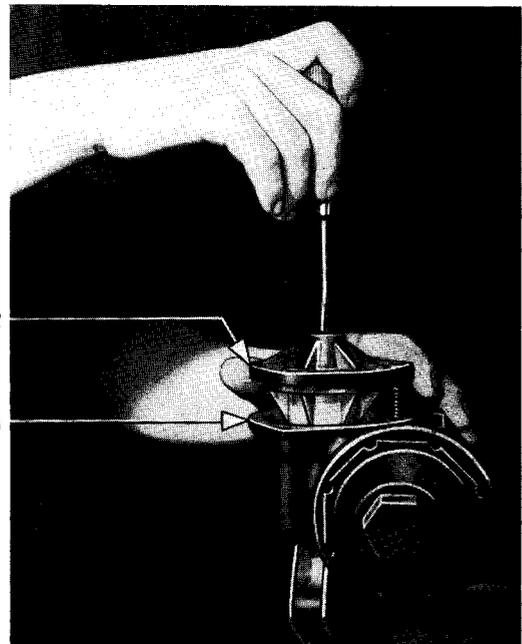
Bild 30 – Einstellschraube mit Schraubenzieher in Lenkgehäusedeckel einschrauben (an ausgebaute Lenkung bzw. ausgebautem Lenkgetriebe gezeigt)
