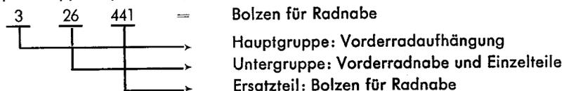
Die Bildtafeln zeigen alle innerhalb einer Untergruppe vorkommenden Ersatzteile einzeln bzw. deren Zusammengehörigkeit als Aggregat in aufbaumäßiger Folge. Sie dienen dazu, bei Bestimmung benötigter Teile Fehlanforderungen auszuschließen. Bei nicht mit einer Ersatzteile-Nummer versehenen Teile innerhalb der Bildgruppen handelt es sich um Normteile.
